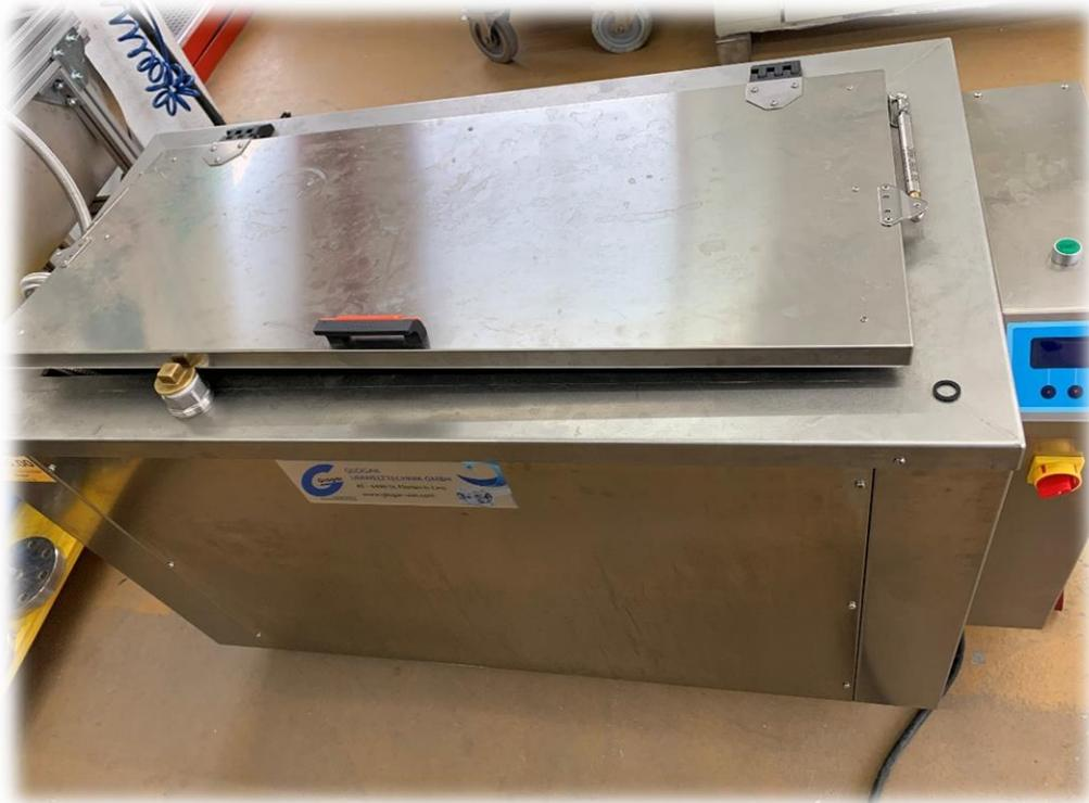
Beim Reinigungsprozess wird mit einem weinsäurehaltigen Reiniger gearbeitet. Unsere Produkte verlangen einen hohen Stand an Sauberkeit, d.h. die gereinigten Teile müssen rein, fleckenfrei und trocken sein. Die Anlage ist nicht geeignet zum Entfetten. Flexiblen Komponenten stellen extreme Anforderungen an eine Reinigungsanlage:
